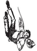
**El lazo salvavidas retráctil** es ambos un lazo salvavidas vertical y dispositivo de deceleración. Consiste de una línea en cilindro que desenrolla y retrae desde el cilindro mientras se mueve el trabajador. Si el trabajador se cae, el cilindro automáticamente se encierra.
