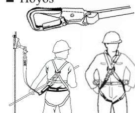
**Otros Peligros:** Protección contra caídas es requerido para obreros expuestos a los peligros de caídas a equipo peligroso o cualquier rampas elevadas, pistas, pasillos, o superficie de trabajo.
